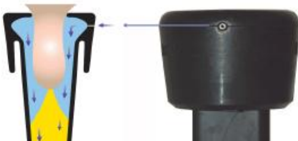
Figuur 1: driehoekige tepelvoering met kopbeluchting (DRK)
